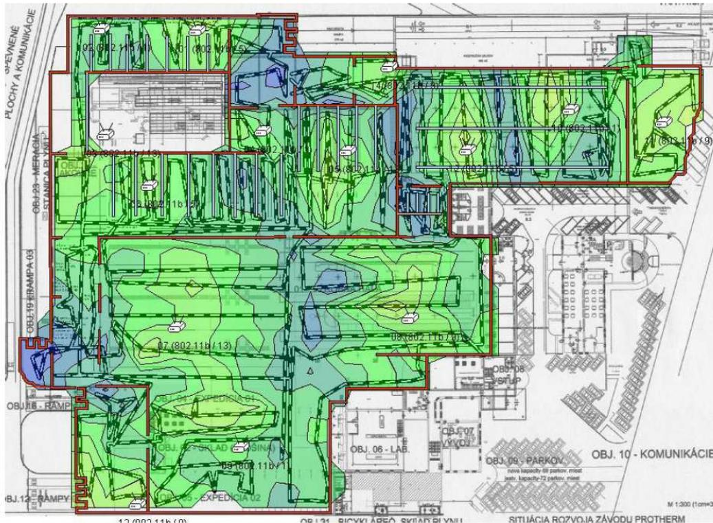
Signal Rauschabstand:  $SNR \text{ (dB)} = \text{Signalstärke} - \text{Interferenzen}$
